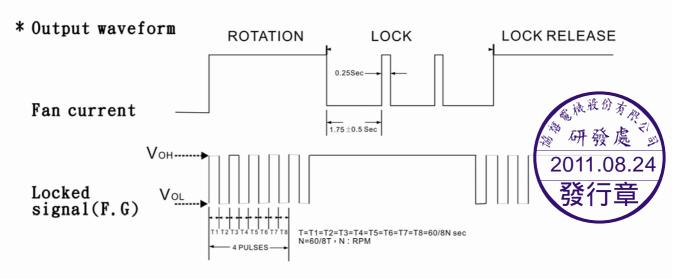
※此顆 IC目前有Power Noise的問題點,但不影響DC FAN及系統之運作,建議於系統供應DC FAN之正負電源端加一47μF之電容。
